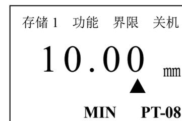
**说明：** 启用最小值捕获后，探头与工件耦合时，屏幕显示的是当前测量值；当探头抬起时，屏幕显示的是测量中的最小值，并且最小值标志 MIN 闪烁 6 次。如果在 MIN 闪烁期间继续测量，当前测量值将继续参加最小值捕捉，如果 MIN 停止闪烁后再进行测量，将重新捕捉最小值。
