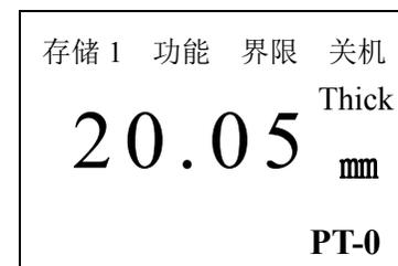
测量厚的标准试块, 同样通过△或▽键将测量值调整到标准值, 再按 CAL 键, 完成校准操作, 就可以进行测量。
