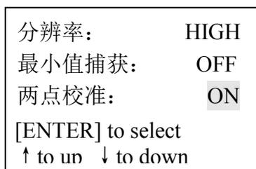
②设置完毕后, 按 MENU 键返回主界面。如果两点校准被设为 ON, 那么在测量的状态下可随意进行两点校准。
