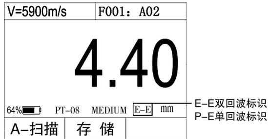
图 3.9 穿透涂层模式厚度测量界面
